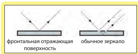
Зеркала с фронтальной отражающей поверхностью
