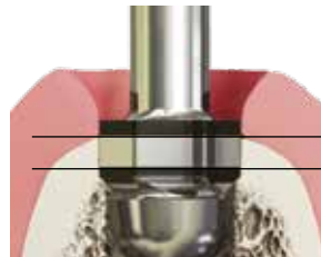
Пример № 2: установка на уровне гребня. Используется вся режущая кромка бора
