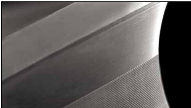
С помощью сканирующего электронного микроскопа видны микроканалы при увеличении в 1000 раз
